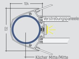
i Die Stele Y3 mini wird per LED ausgeleuchtet. Bei Stelen bis zu 2 m Größe sind die Leuchtmittel oben und unten angebracht. Bei Stelen über 2 m werden sie seitlich angebracht. Die Stromzuleitung der Beleuchtung befindet sich mittig im Stelenboden.
