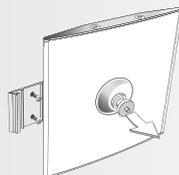
Alu Clic Montageplatte positionieren und anschrauben. Auf die richtige Wahl der Dübel achten. System-schild von einer Seite zur anderen auf die Montageplatte ziehen, danach mit einem kräftigen Ruck das Schild andrücken bis es einrastet. Beim Einrasten ist ein „Klicken“ zu hören.
